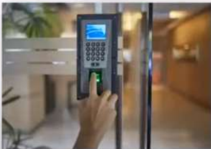
Controle de acesso por meio de impressão digital
