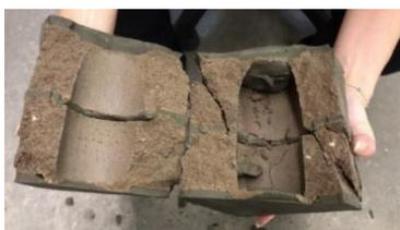
**Figura 8:** Rompimento do tijolo ecológico com argila expandida
