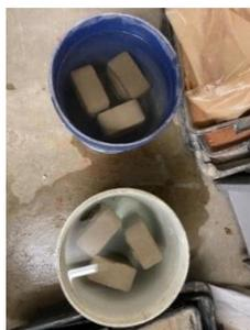
**Figura 9** – Imersão de 24h dos tijolos (ABNT NBR 8492, 2012)
