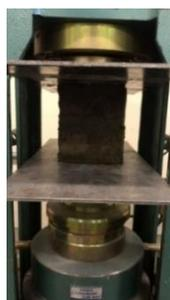
**Figura 7:** Posicionamento das placas metálicas e do tijolo
